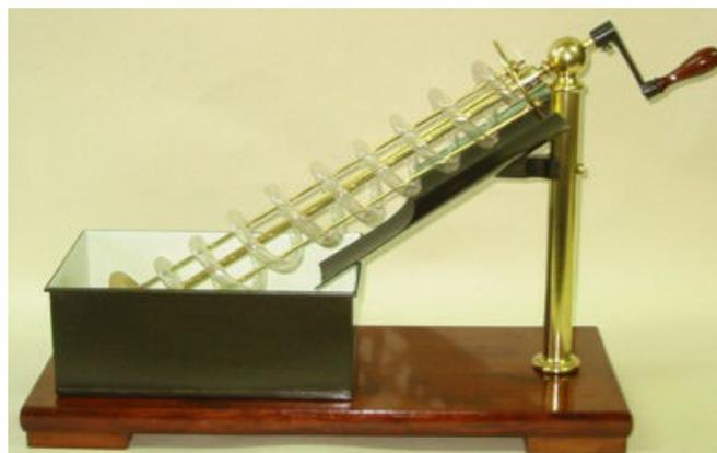
A geometria do parafuso de Arquimedes tem em conta certos parâmetros, tais como o raio externo, o comprimento, o raio interno, o número de voltas e o passo da espiral. Os parâmetros externos são usualmente determinados pela localização do parafuso e pela quantidade de água que vai ser elevada. Os parâmetros internos podem ser escolhidos de modo a otimizar o desempenho do parafuso.
